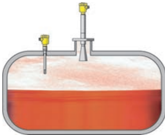
Depósito de almacenamiento de líquidos tóxicos con medidor e interruptor de nivel instalados.
