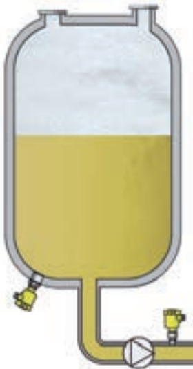
Depósito de cloro con transmisores de presión VEGABAR 82 para la medida de nivel en depósito y de presión en tubería.
